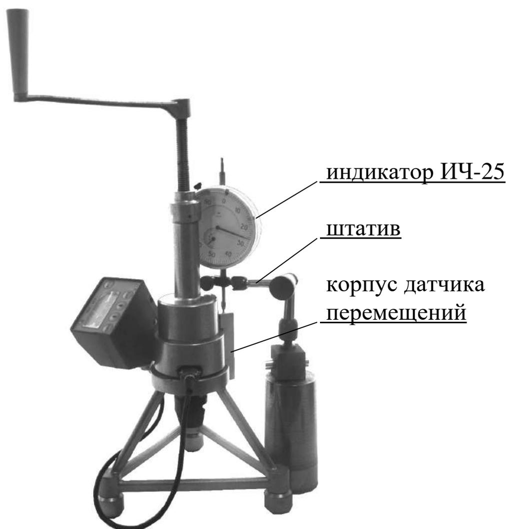
Рисунок 14 – Проверка датчика перемещений
