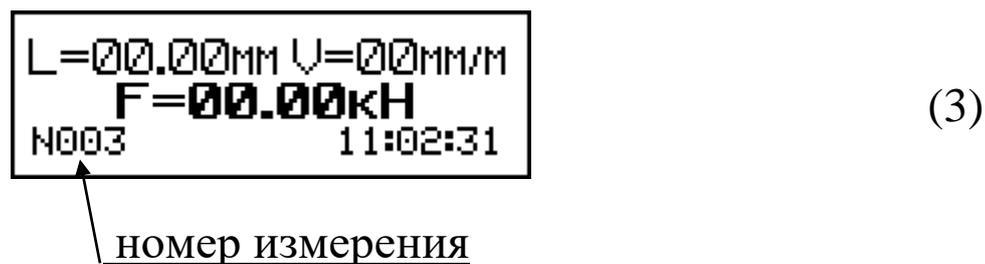
2.2.1.2 Равномерно вращая рукоять нагружения по часовой стрелке, произвести нагружение анкерного изделия, дисплей при этом имеет вид, например:
